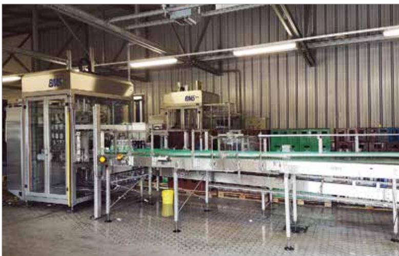
Ein Herzstück der realisierten Lösung sind zwei Sortierpacker in Portalbauweise. Foto: BMS Maschinenfabrik GmbH
