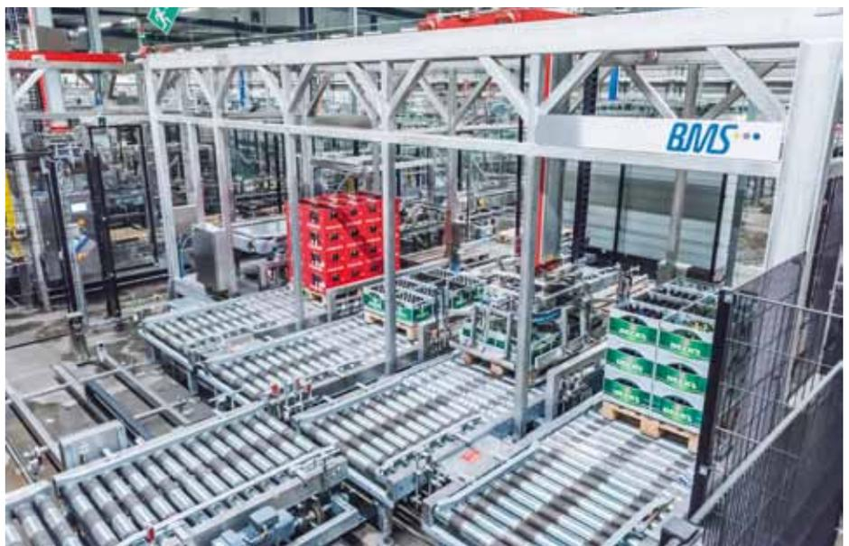
Die Palettierer der Sortieranlage wurden alle als Portalroboter ausgeführt
