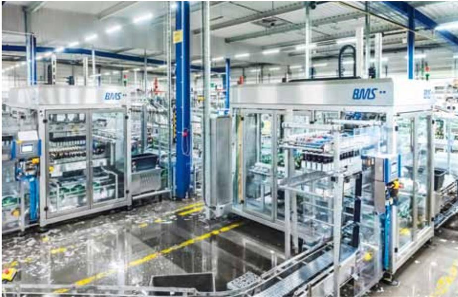
Die beiden Hauptsorteneinpacker waren die ersten BMS-Zehnkopfmaschinen in einer Sortieranwendung
