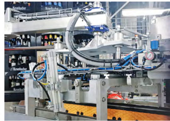
Das Magazin puffert bereits sortiertes Leergut. Dieses wird zuerst von einem Säulenpalettierer zu Blöcken aufgestapelt.
