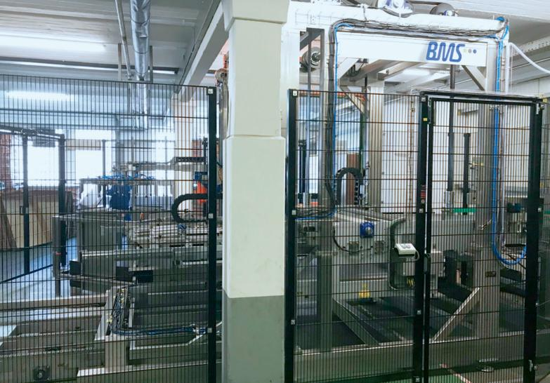
*Durch modulare Anpassungen wird aus der Grundmaschine des Neubehälterabschiebers ein Belader, Entlader oder kombinierter Be- und Entlader.*
