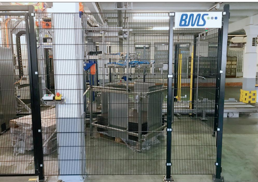
*Der eigentliche Neuglasabschieber nimmt in etwa die Grundfläche von drei Euro-Paletten ein und ist nur einen Meter höher als das Ladegut selbst. Darüber hinaus vereinfacht er das Handling der Stülpdeckel, der Zwischenlagen und der Leerpalletten.*
