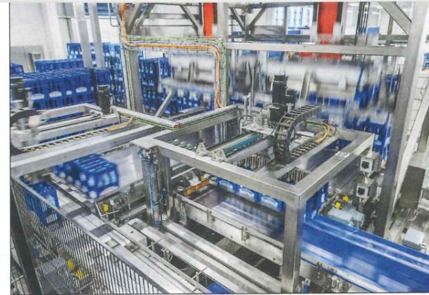
Um trotz der hohen Komplexität ausreichend Leergut bereitstellen zu können, wurden die Nadelöhre der Sortierung auf 60.000 Flaschen pro Stunde ausgelegt.
