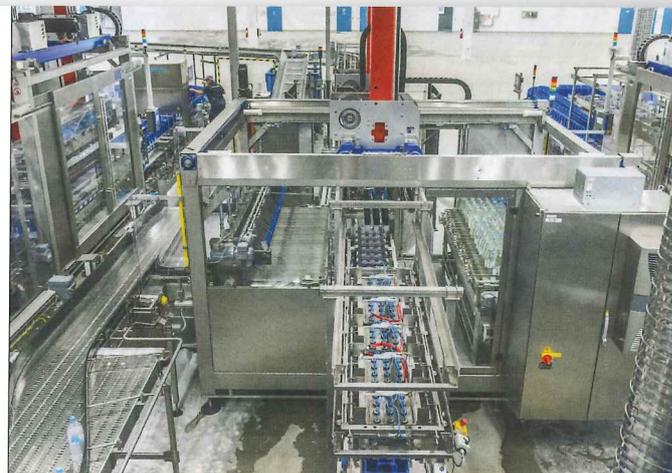
Die sortierten Produktionsflaschen werden im Nassteil befüllt, vom Einpacker in ihren gereinigten Kästen ein- und abschließend von einem Duplexbelader parallel auf zwei Paletten aufgesetzt.
