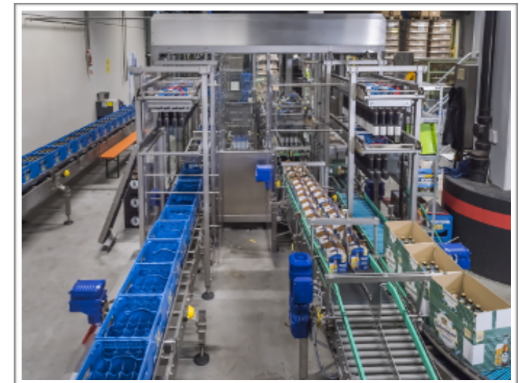
Aufgebaut ist das Umpackmodul als Portalroboter mit zwei Achsen. Zentrale Transportbänder trennen dabei die Ein- von der Auspackseite.
