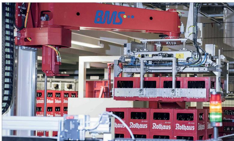
Sowohl beim Be- als auch Entlader entschied sich Rothaus für einen Säulenpalettierer. Fotos: BMS-Maschinenfabrik
