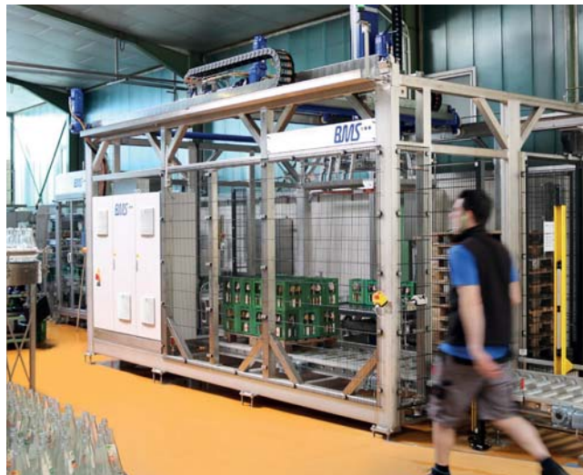
Abbildung 2: Über die Jahre wurden die zu verarbeitenden Kästen und Flaschen immer vielfältiger. Der Schlenkerhof entschied sich daher für einen Portal-Palettierer. © BMS
