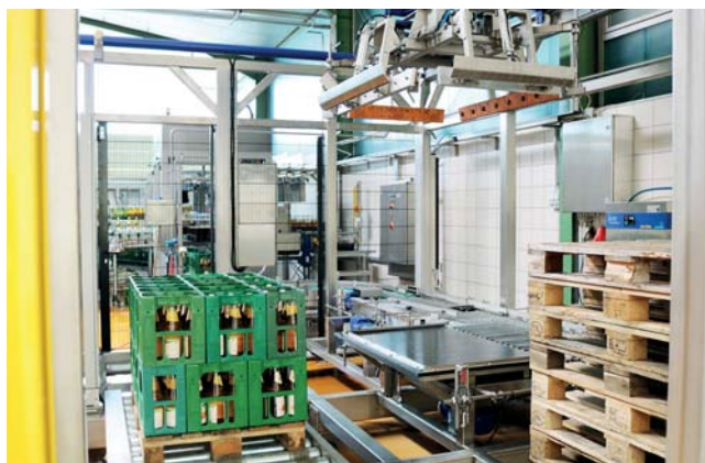
Abbildung 3: Zukunftssicher: Das Palettier-Portal lässt sich mit einer zweiten Achse nachrüsten. Dann wird aus einem reinen Be- ein kombinierter Be- und Entlader. © BMS
