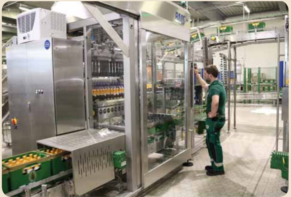
Kernstücke des Projekts waren zwei Portalpacker, neu geordert wurden zudem der Gebinde- und Flaschentransport
